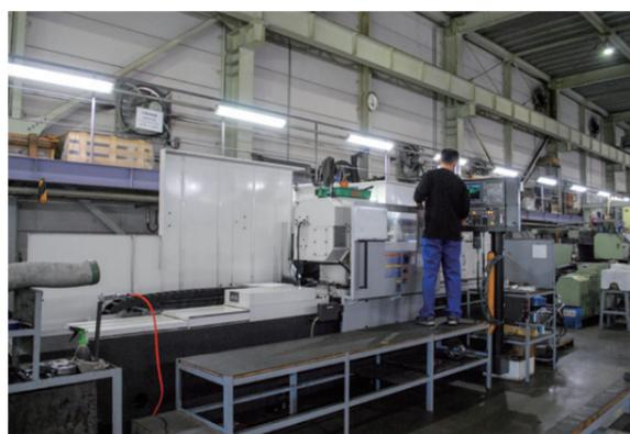
新たに導入した大型CNC円筒研削盤。熟練者でも長時間の作業を必要とした研削加工時間の25%削減を実現する。データの数値化により、作業の標準化、一元化も可能となった
