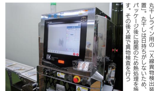
丸干しライン用の「X線異物検出装置」。丸干しは日持ちがしないため、パッケージ後に殺菌のため熱処理を施す。その後X線で異物検査を行う
