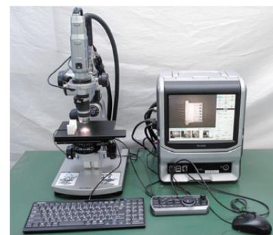
マイクログラフを顕微鏡として利用することで、圧着部分を画像で確認できる
