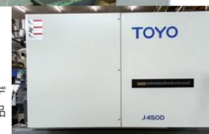
射出装置内のシリンダーに熱を与え、液状になったプラスチックが攪拌されて切断された時に熱が発生し、その熱によりプラスチック材料中に含まれる各種の化学物質や不純物が気化する。これらがノズルから射出されてプラスチック成形製品の表面に残留する。
