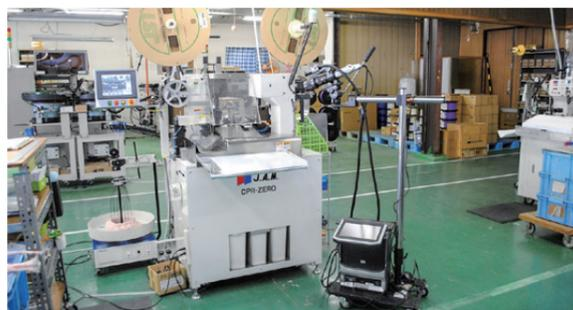
全自動両端端子圧着機の脇にハイスピードマイクログラフを設置し、動画で確認をする
