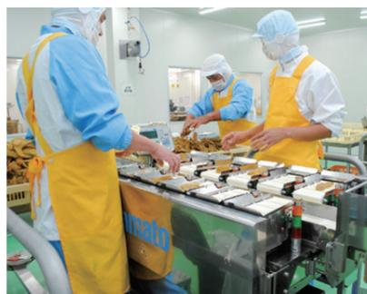
全自動組み合せ秤装置の「自動排出機構付き卓上データウェイ」。あらかじめ機械が不良品を除き、分量ごとに分けられたものが運ばれてパック詰めされる
