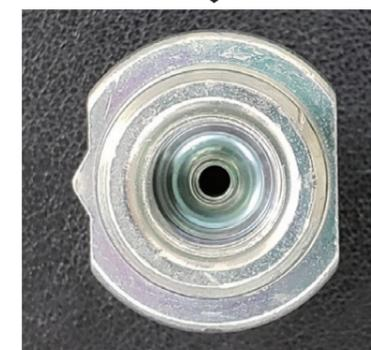
（写真上）従来の照明で照らすと、孔底の部分にまで光が当たっていない（写真下）専用照明で照らした場合、従来のような奥まで光をあてることが可能になった
